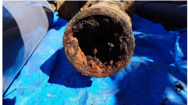
経年劣化による管内の腐食状況
